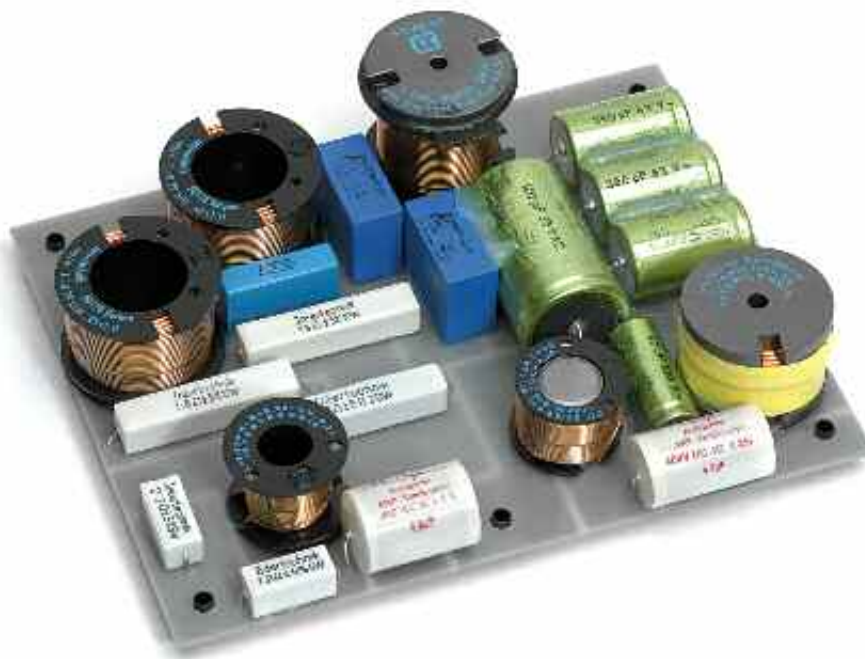
Des Rätsels Lösung: Die Frequenzweiche mit ihren steiflankigen Filtern bildet das Herzstück der Enigma. Für sie kommen daher nur exzellente Bauteile in Frage
