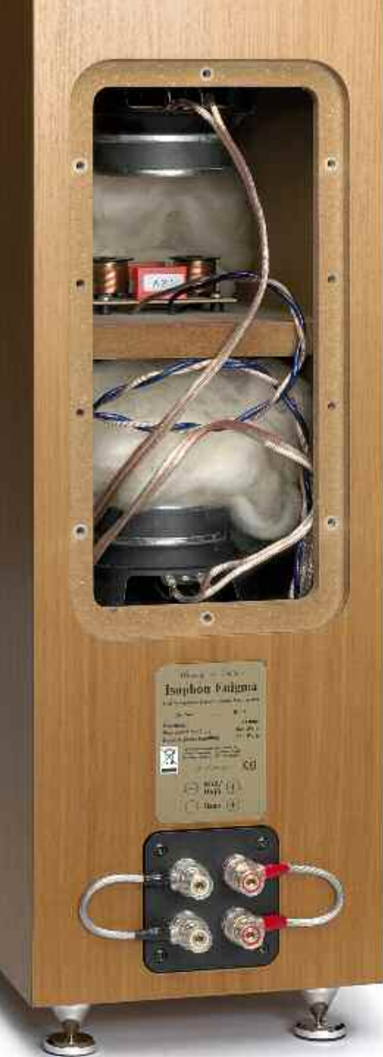
Zweizylinder-Boxermotor: Die beiden Tieftöner arbeiten rückseitig auf geschlossene Kammern, die über eine Serviceabdeckung zugänglich sind
