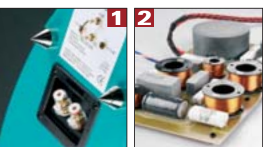
1. Über vergoldete Steckbrücken kann der Bass um +/- 1,5 dB an den Raum angepasst werden. 2. Um ihre enorme Flankensteilheit zu erzielen, braucht die Weiche eine Reihe feiner Bauteile.
